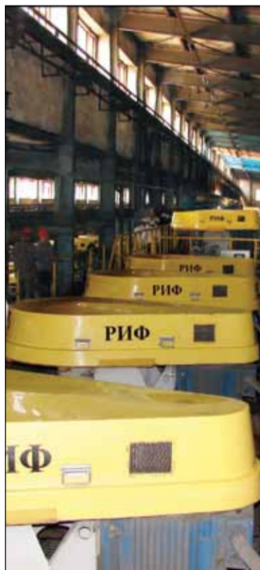
Նոր տեղադրված 25 խմ սարողությամբ (նախկին 3.2 խմ փոխարեն) ֆլոտացիոն մեքենաներ
